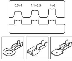
**HERRAMIENTA DE CRIMPADO CON REDUCCIÓN PARA TERMINALES DE LATÓN ABIERTOS DE BARRIL DE 0,5 A 6 MM<sup>2</sup> (AWG 20-10)**
