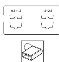
**HERRAMIENTA DE CRIMPADO PARA TERMINALES HEMBRA AISLADOS DE CONEXIÓN RÁPIDA DE 0,5 A 2,5 MM<sup>2</sup> (AWG 20-14)**
