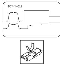
**HERRAMIENTA DE CRIMPADO CON REDUCCIÓN PARA TERMINALES DE BANDERA HEMBRA DE CONEXIÓN RÁPIDA - 2,5 MM<sup>2</sup> (AWG 14)**
