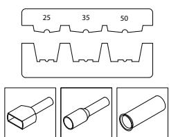
**HERRAMIENTA DE CRIMPADO CON REDUCCIÓN PARA PUNTERAS DE 25 A 50 MM<sup>2</sup> (AWG 4-1)**
