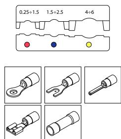
**HERRAMIENTA DE CRIMPADO CON REDUCCIÓN PARA TERMINALES AISLADOS DE 0,25 A 6 MM<sup>2</sup> (AWG 22-10)**
