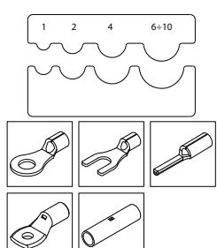
**HERRAMIENTA DE CRIMPADO CON REDUCCIÓN PARA TERMINALES DE COBRE NO AISLADOS DE 0,5 A 10 MM<sup>2</sup> (AWG 20-8)**
