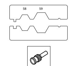
**HERRAMIENTA DE CRIMPADO CON REDUCCIÓN PARA CONECTORES COAXIALES RG58-59**
