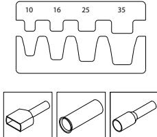
**HERRAMIENTA DE CRIMPADO PARA PUNTERAS DE 10 A 35 MM<sup>2</sup> (AWG 8-2)**
