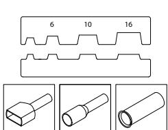
**HERRAMIENTA DE CRIMPADO CON REDUCCIÓN PARA PUNTERAS DE 6 A 16 MM<sup>2</sup> (AWG 10-6)**
