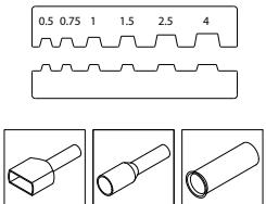
**HERRAMIENTA DE CRIMPADO CON REDUCCIÓN PARA PUNTERAS DE 0,5 A 4 MM<sup>2</sup> (AWG 22-12)**
